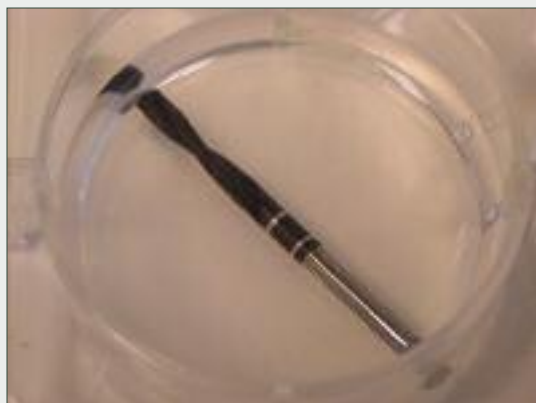
Fig. 2 Immagine macroscopica della fresa in acciaio AISI 630 rivestita TiAlN posta nel contenitore per cellule al termine delle 72 ore di incubazione.
