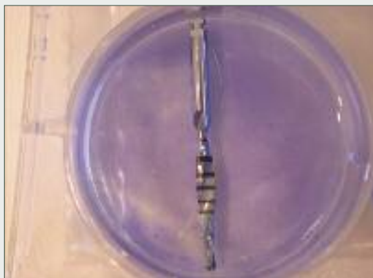
Fig. 3 Immagine macroscopica della fresa in acciaio AISI 630 non rivestita posta nel contenitore per cellule dopo il processo di colorazione con blu di toluidina.
