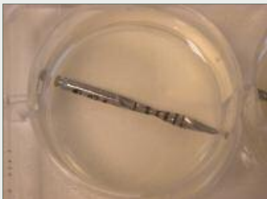
Fig. 1 Immagine macroscopica della fresa in acciaio AISI 630 non rivestita posta nel contenitore per cellule al termine delle 72 ore di incubazione.
