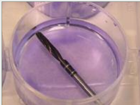
Fig. 4 Immagine macroscopica della fresa in acciaio AISI 630 rivestita TiAlN posta nel contenitore per cellule dopo il processo di colorazione con blu di toluidina.
